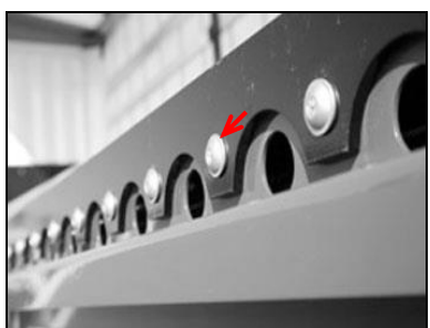
Graničnik palete, spojen vijcima
