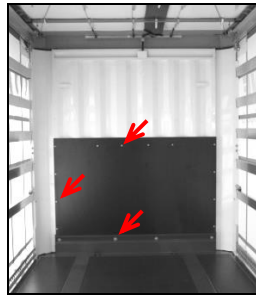
Ploča čeonog zida
